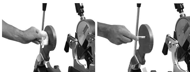
Очищення зварювального дзеркала. Оберігайте тефлонове покриття
