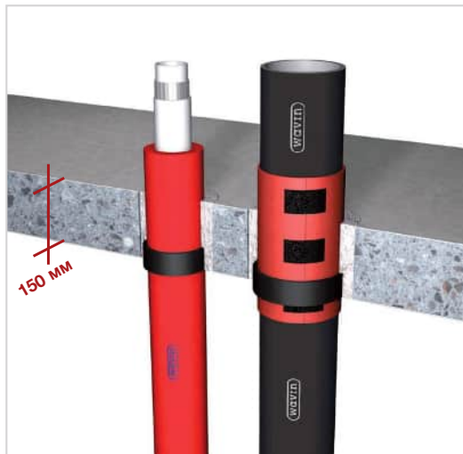
Пряме прокладання труб крізь стелю.
