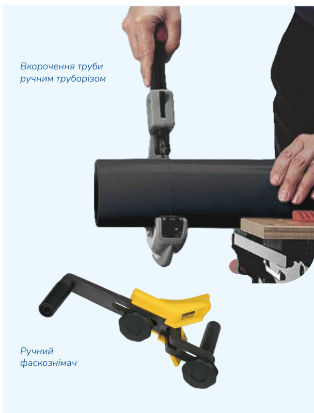
Ручний інструмент для різання труб та обробки їх країв (зняття фаски)
