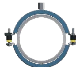
Ковзний хомут: наявні жовті проставки (стан при постачанні)
