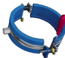
Переведення трубного хомута зі стану ковзної опори у нерухому: проставки легко видаляються звичайною пласкою викруткою.
