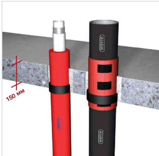
Пряме прокладання труб крізь стелю.
