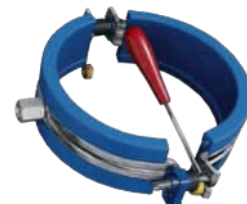
Переведення трубного хомута зі стану ковзної опори у нерухому: проставки легко видаляються звичайною пласкою викруткою.
