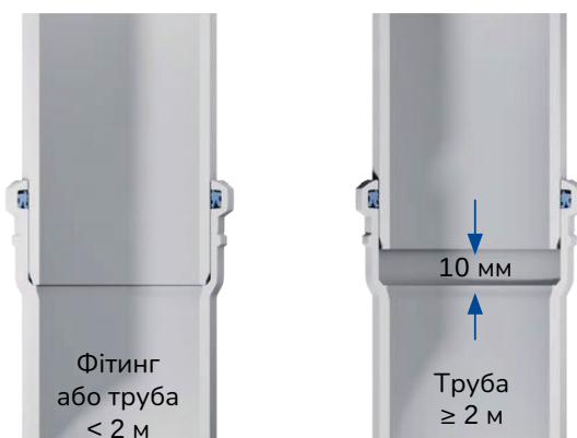
Схема компенсації лінійного теплового розширення - тепловий зазор
