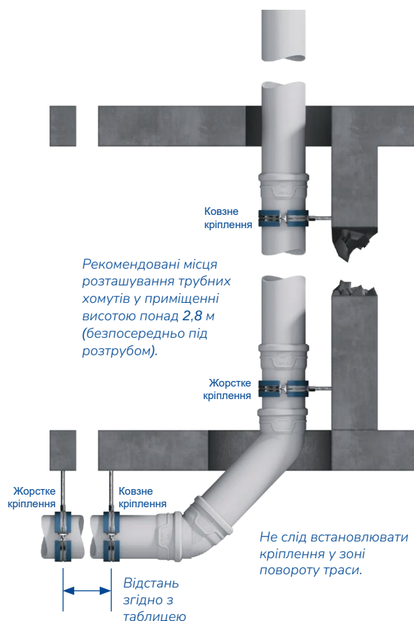
Приклад вертикального й горизонтального кріплення трубопроводу
