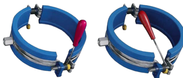
Переведення трубного хомута зі стану ковзної опори у нерухому: прокладки легко видаляються звичайною плоскою викруткою.
