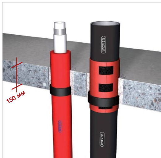
Пряме прокладання труб крізь стелю.
