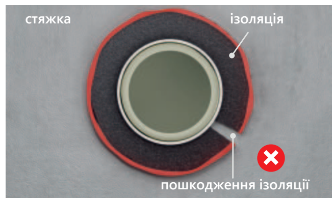
Передача структурного шуму та втрати тепла внаслідок пошкодженої ізоляції труби
