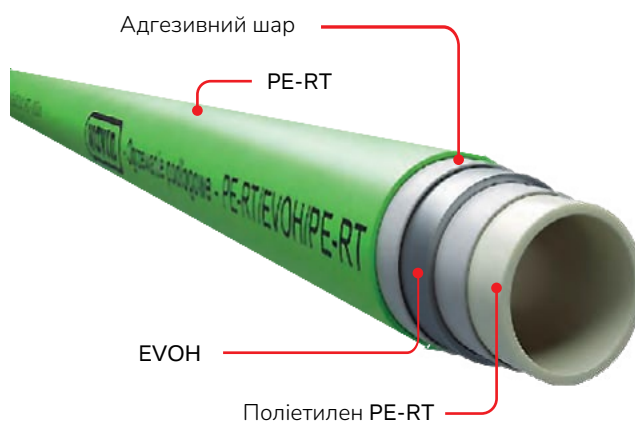
Будова багатошарової композитної труби
