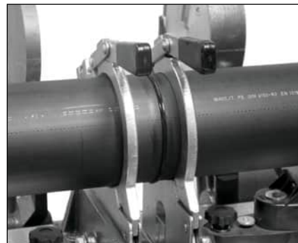
Охолодження звареного з'єднання
