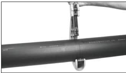
Різ труби роликовим труборізом
